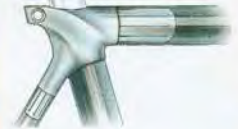
MUFFEN: Jede Aluminium Muffe wird mit präzisen Winkeln je nach spezifischer Rahmengröße gefertigt und wird, wie in der Luftfahrt, zur besseren Haltbarkeit anodisiert. Das Ergebnis: ausgewogene Rahmengenometrie, bequemes Fahren und höhere Rahmenstabilität.
