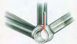
TRETLAGER: Das einzigartig geschmiedete Design bietet einen größeren Radius für jede Muffe und verstärkt die Rippen in den kritischen Punkten für einen größeren Oberflächenbereich. Diese Kriterien ergeben zusammen mit der harten Anodisierung zur Haltbarkeit, zusätzliche Kraft und Steifigkeit für eine bessere Kraftübertragung und eine höhere Seitensteifigkeit im Tretlager.
